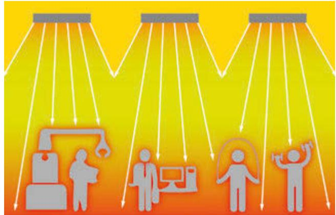
Um beispielsweise eine Empfindungstemperatur von 20°C zu gewährleisten, genügt eine Erwärmung der Raumluft mittels Deckenstrahlplatten auf 17°C.
