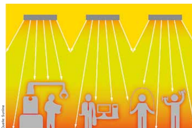
Funktionsprinzip von Deckenstrahlplatten
